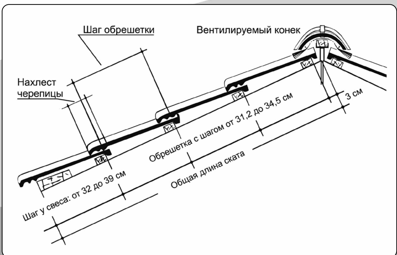
На стр. 31 приведена таблица, которая позволяет быстро определить средний шаг обрешетки и количество рядов в зависимости от длины и угла наклона ската.
