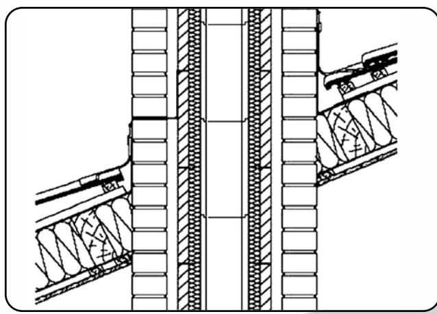
Если температура наружной поверхности трубы не превышает  $80^{\circ}\text{C}$ , заверните лепестки пленки наверх и приклейте двусторонним бутиловым скотчем к трубе.
