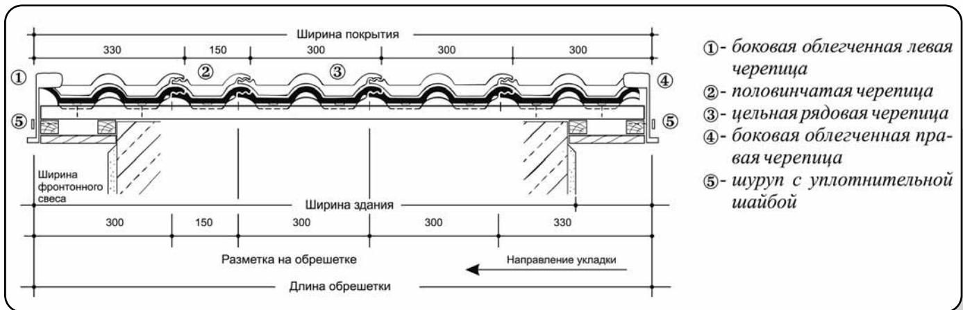
Точная подгонка ширины покрытия обеспечивается применением половинчатой черепицы (2) и свободного люфта 3 мм в каждом стыке черепиц. (Например, при ширине ската 10 м длину ряда можно увеличить на 9,9 см!)
