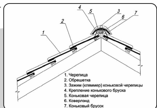
*Разрез с применением гидроизоляционной пленки, аэроэлементов конька AFE, Фигарол и Металлпрол вентилируемого конька.*
