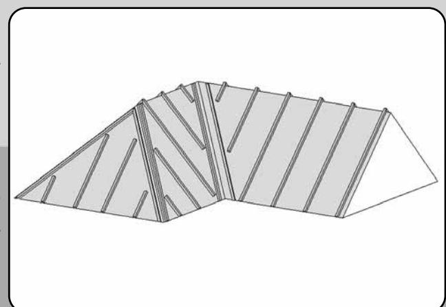
**Схема устройства контробрешетки**
