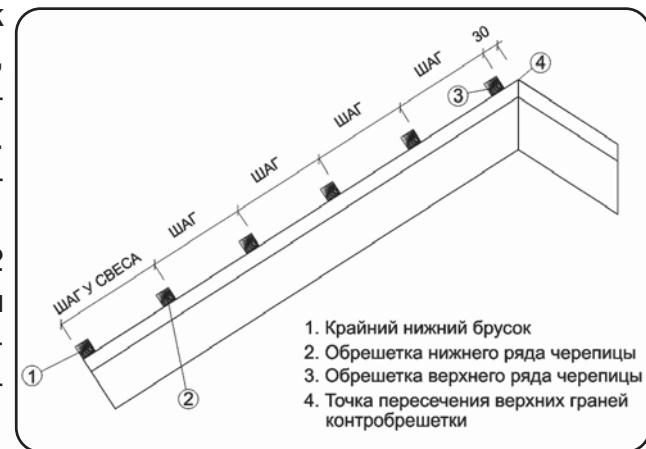
**Примечание:** Для более качественного устройства конька, при увеличении угла наклона крыши более 30°, расстояние можно уменьшить до 2 см.
